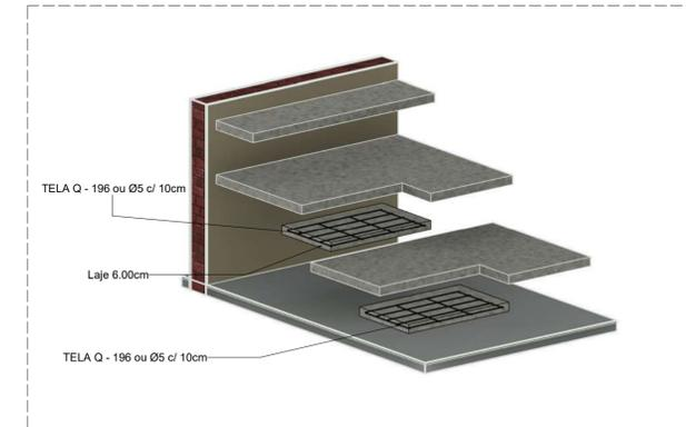
8 DETALHE DE ARMAÇÃO DOS DEGRAUS DAS ESCADAS
